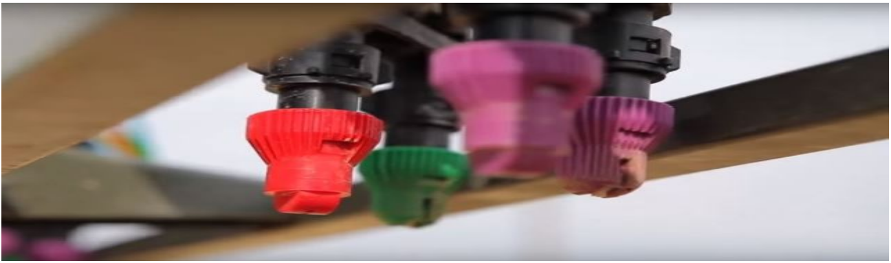
Le système Vario-Select de Tecnomat assure une coupure électrique individuelle de buse. (© Tecnomat)
