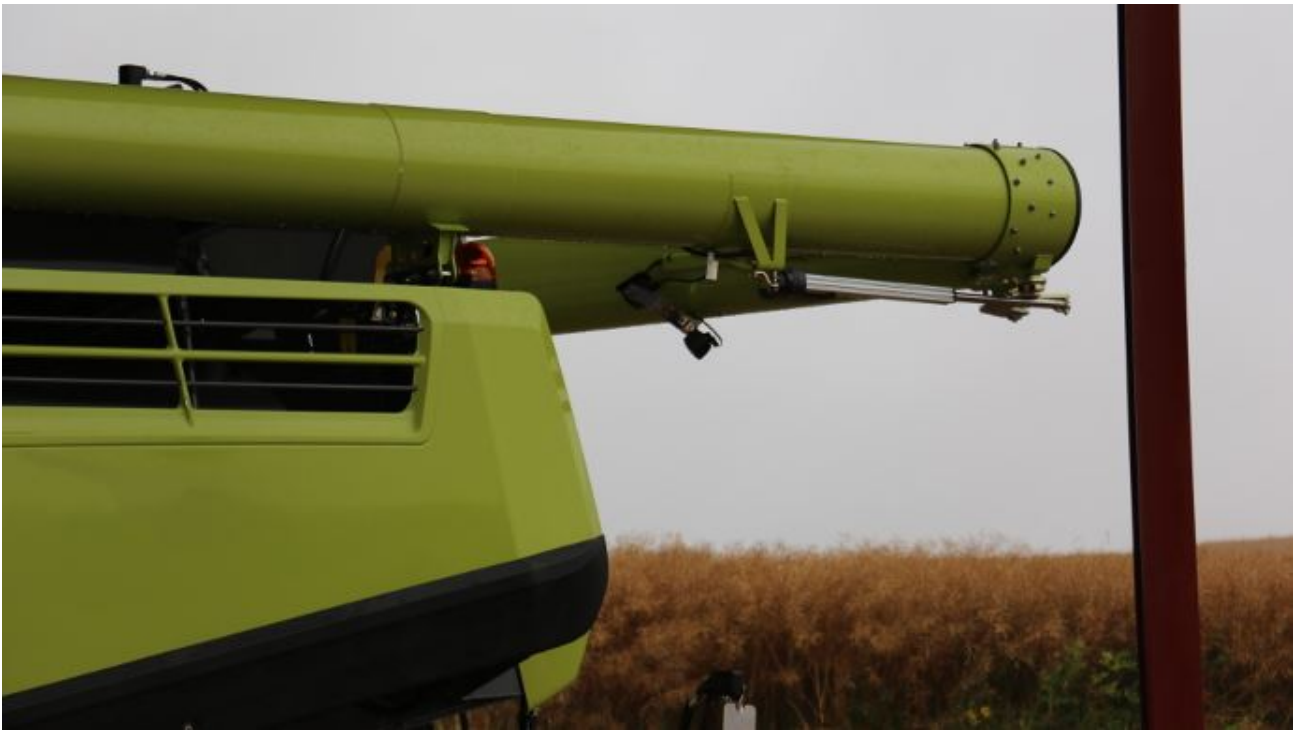
En position transport, 2,11 m de la vis sont rabattus derrière la batteuse. (©Terre-net Média)
