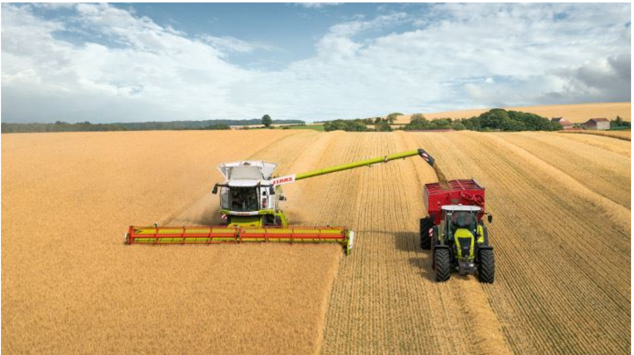
La vis de vidange 7XL permet à la remorque de transport de circuler dans les traces de la Lexion. (©Claas)
