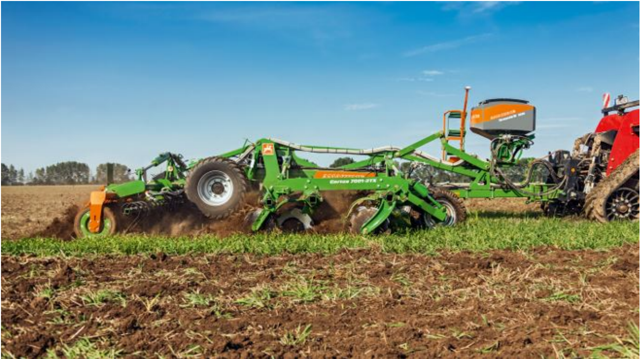
Le semoir Amazone Green Drill s'installe sur le timon du déchaumeur Certos ou Catros. (©Amazone)
