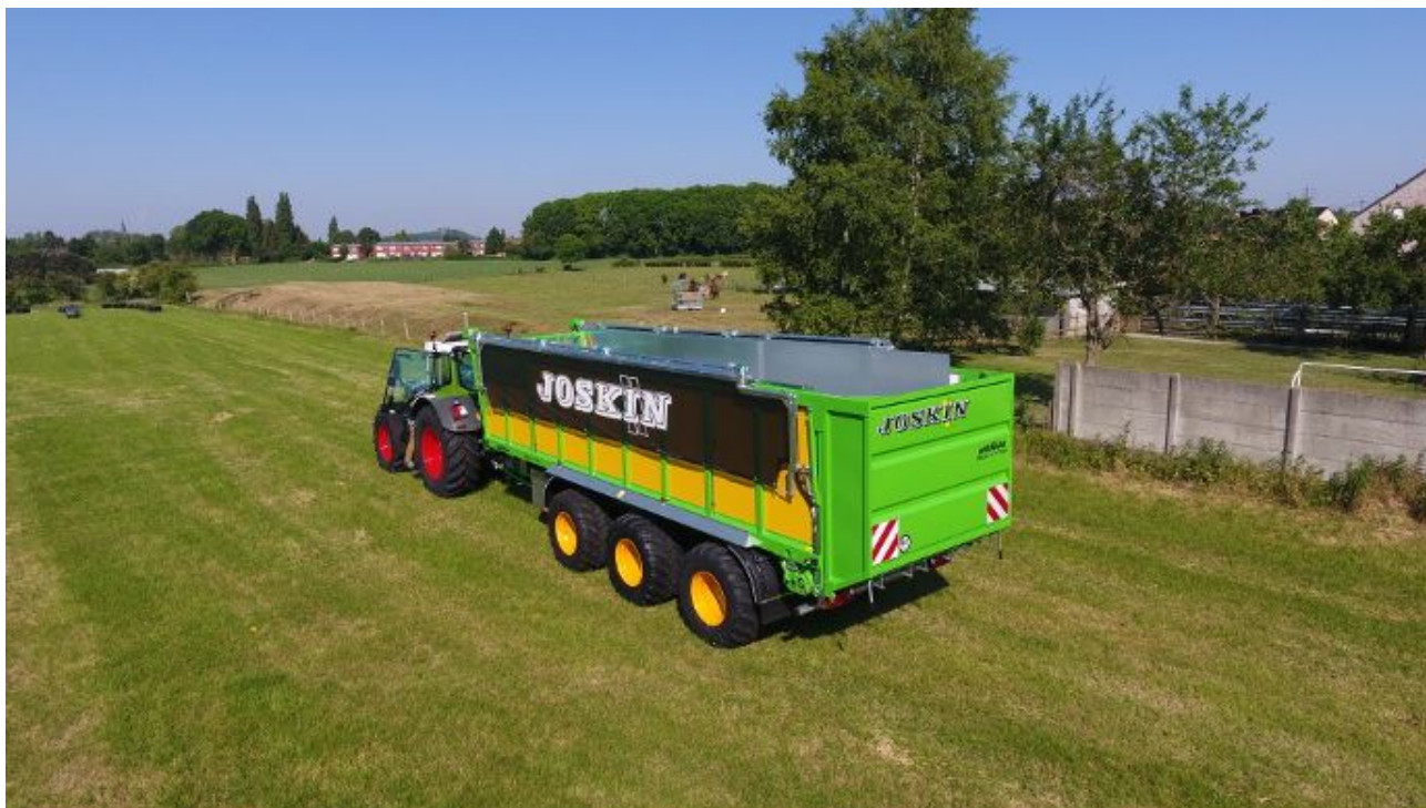
Les filets Duo-Cover pivotent à 270° pour couvrir le dôme et ne pas perdre d'ensilage sur la route. (©Joskin)
