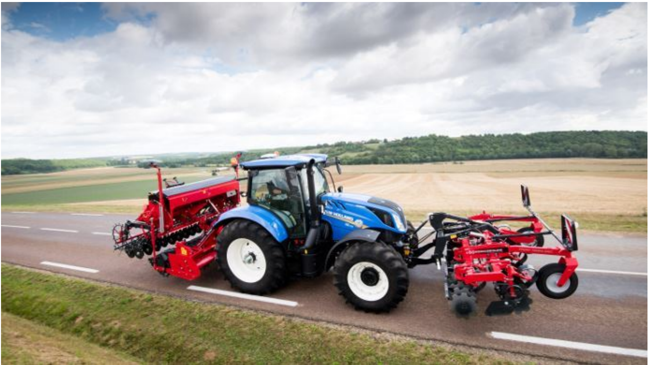
La version Dynamic Command bénéficie d'une transmission à huit rapports et d'un double embrayage. (©New Holland)
