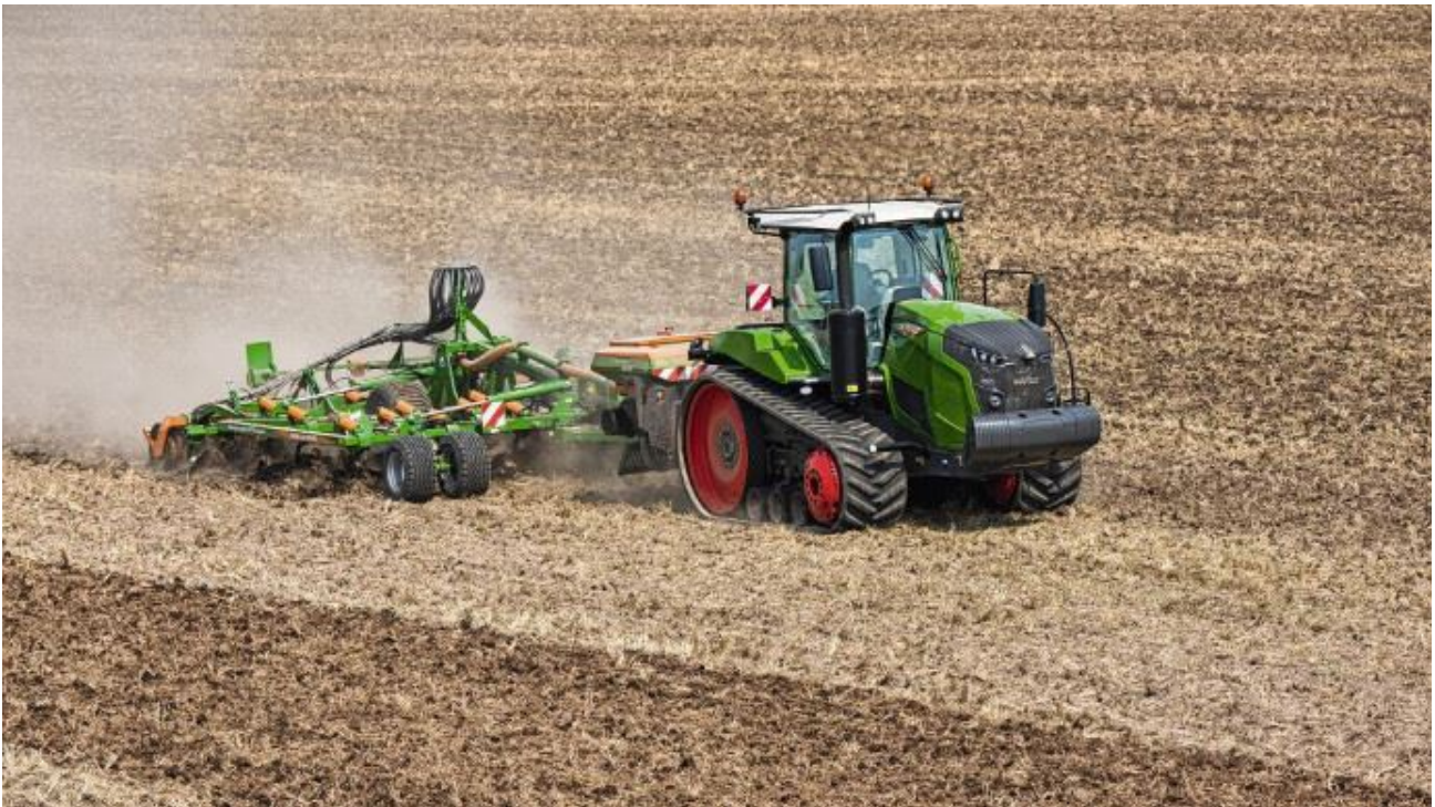
Le tracteur à chenilles Fendt 900 Vario MT développe de 380 à 431 ch. (@Fendt).
