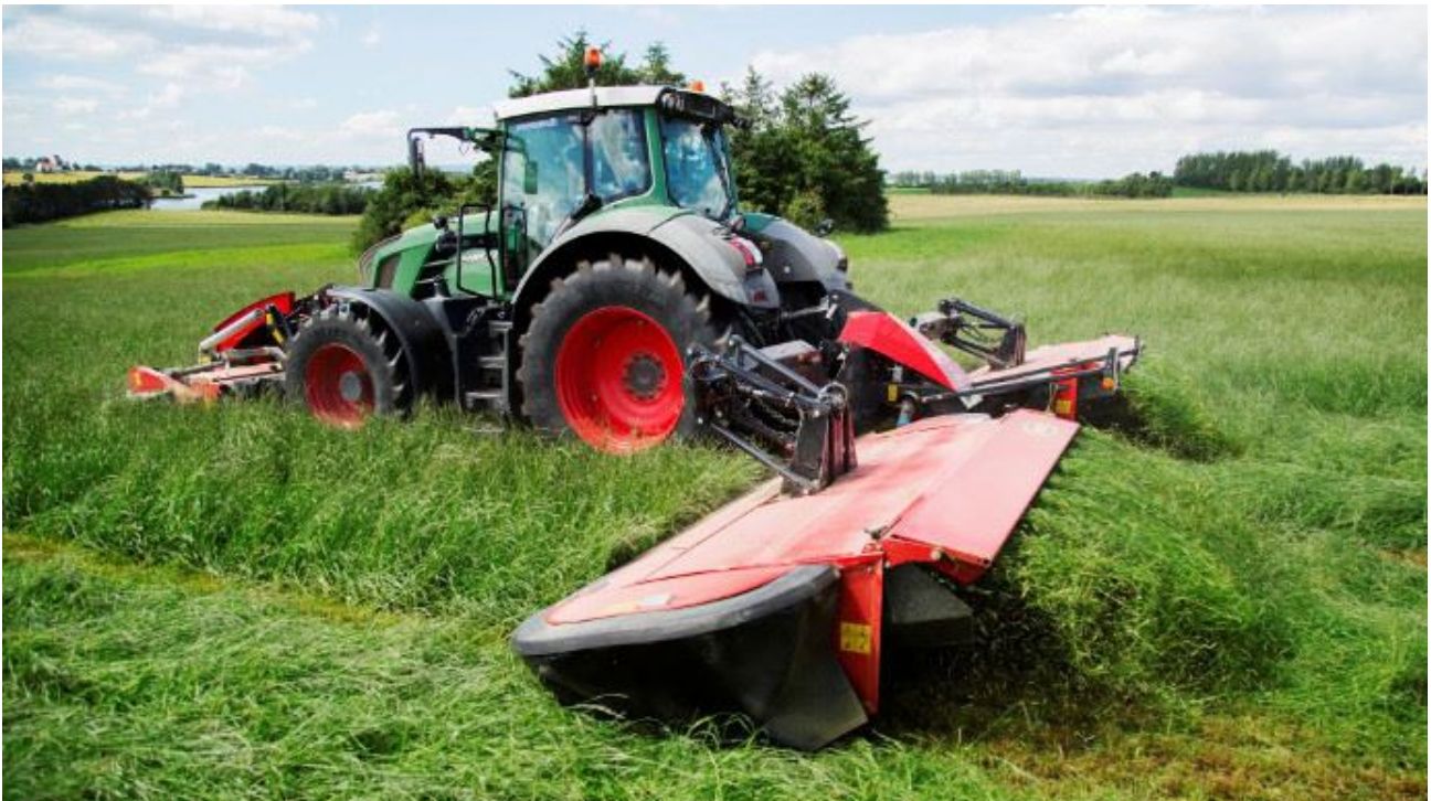
La technologie GeoMow contrôle les sections de la faucheuse. (©Vicon)
