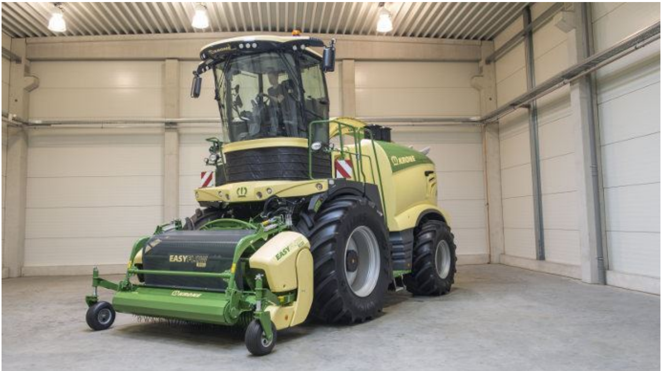
Krone Big X880 avec le prototype de la cabine en position surélevée. (©Krone)
