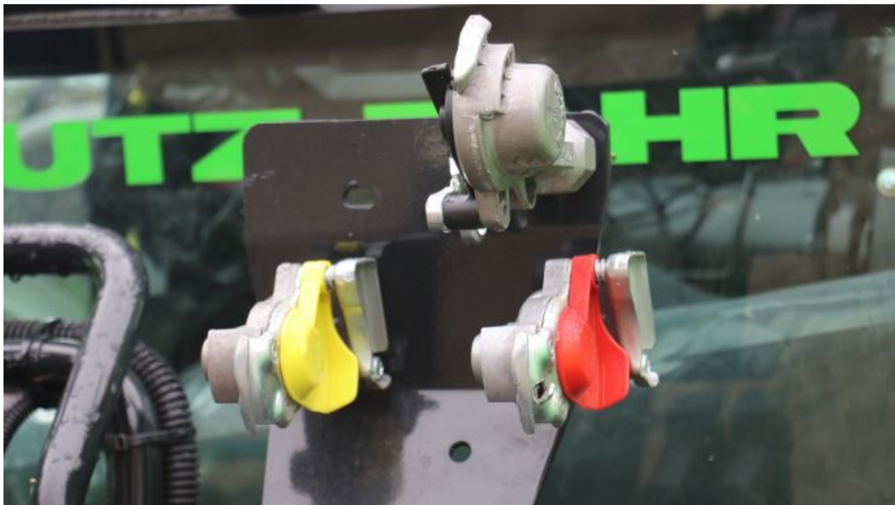
La double ligne de freinage stoppe le convoi en cas de rupture d'attelage de la remorque. (©Terre-net Média)
