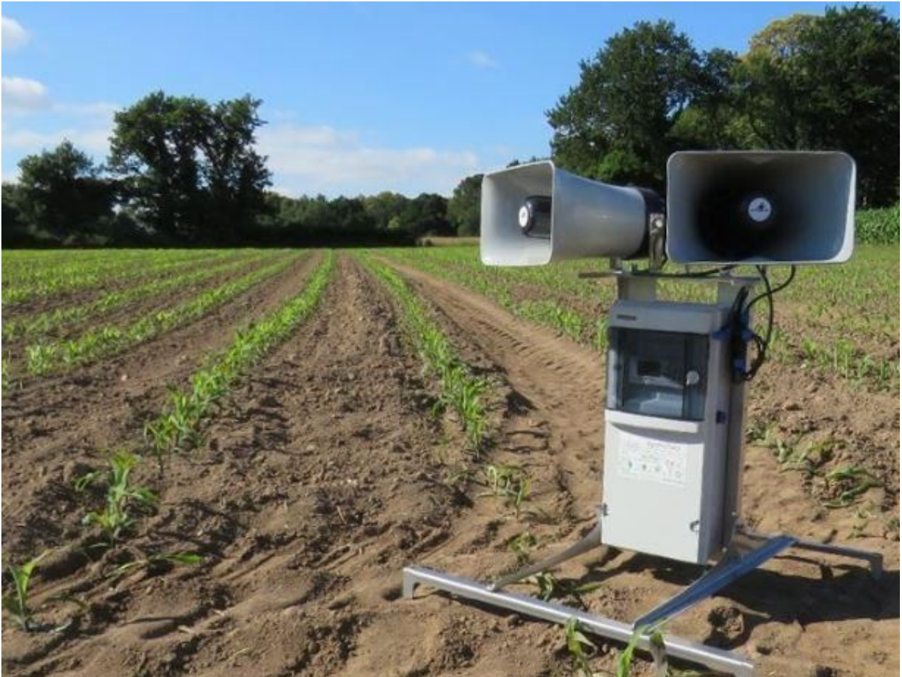
L'effaroucheur à oiseaux AviTrac 18S protège une surface de quatre hectares. (©AgriProTech)
