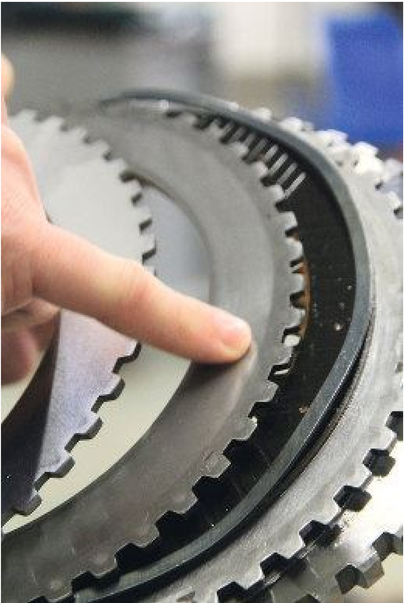
Disque d'embrayage dans la transmission d'un tracteur (©Gima)
