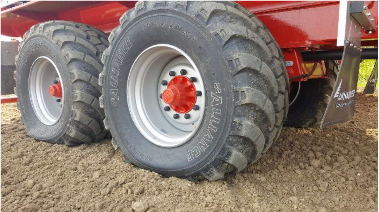
Alliance a développé une gamme de pneumatiques VF pour les remorques, pulvérisateurs et épandeurs pour réduire la compaction du sol. (©Alliance Tire Group)
