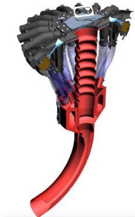
Horsch RowControl, une nouvelle tête de répartition pour une coupure de rang sur chaque ligne. (©Horsch)
