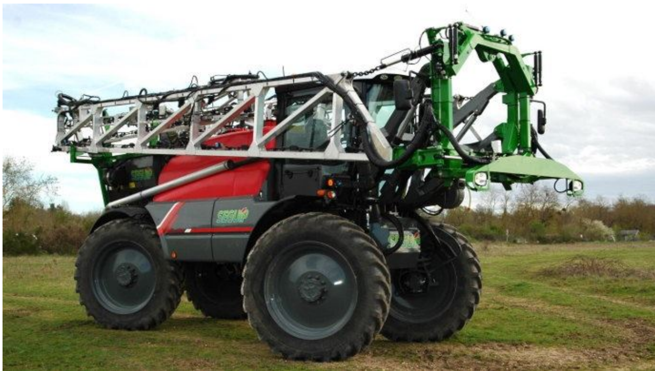
Seguir APX Vision, une nouvelle rampe avant pour supprimer les angles morts. (©Seguir)
