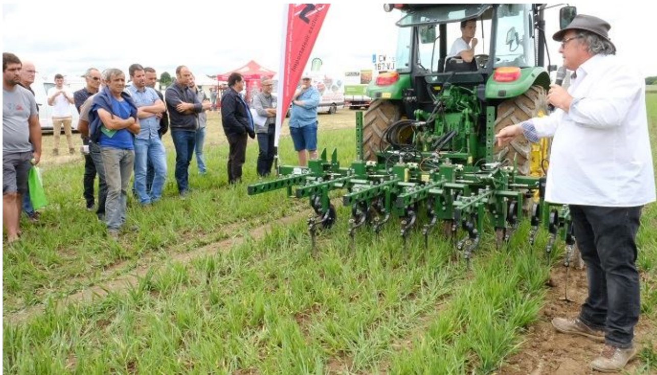
Sur le salon Désherb'expo, démonstration de la bineuse Garford pour grandes cultures avec guidage par caméra vidéo Robocrop précis à 1,5 cm. Elle peut travailler jusqu'à 12,5 cm d'inter-rangs, et sa vitesse peut atteindre 15 km/h. (©Nathalie Tiers)
