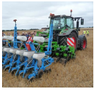
Combinaison du strip-tiller avec le semoir monograine (©Arvalis- Institut du végétal)
