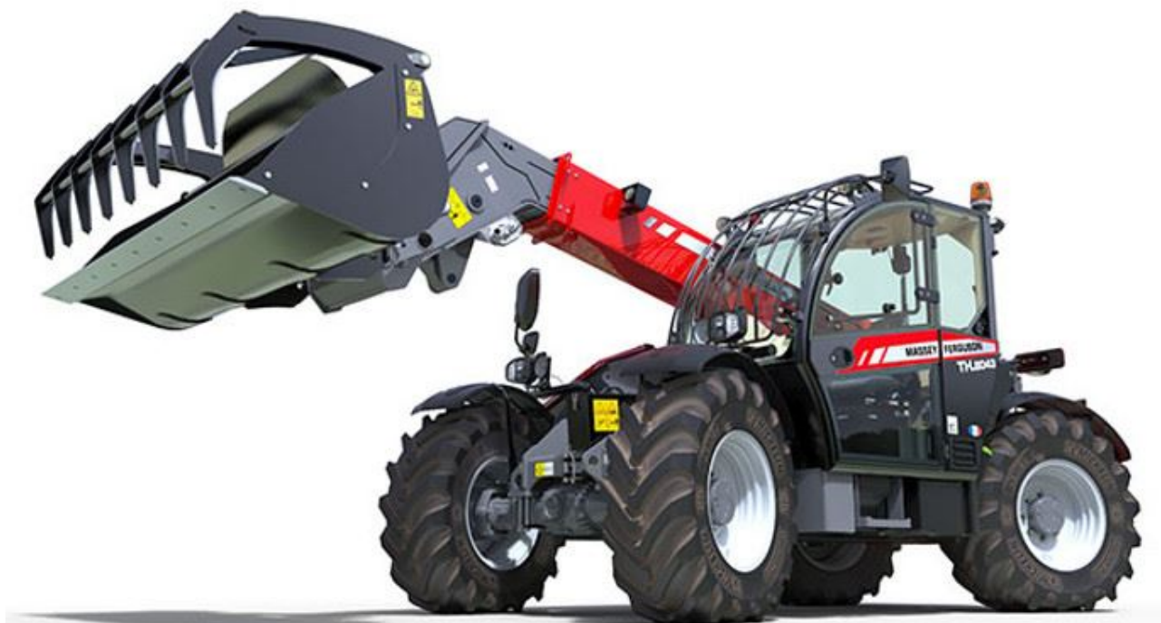
Le télescopique Massey Ferguson TH.8043 bénéficie de 4,3 t de capacité de levage et lève à plus de 7,5 m de haut. (@Massey-Ferguson)
