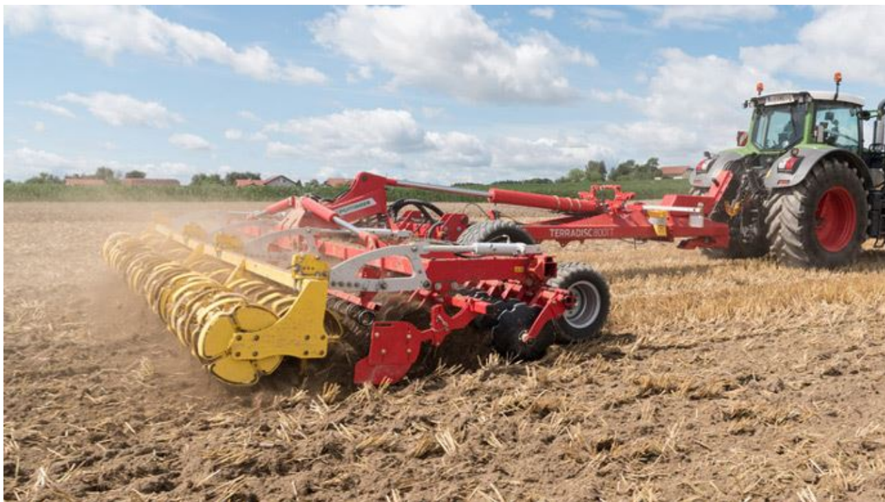
Les deux nouveaux déchaumeurs à disques de Pöttinger travaillent 8 ou 10 m de largeur à 18 km/h. (©Pöttinger)
