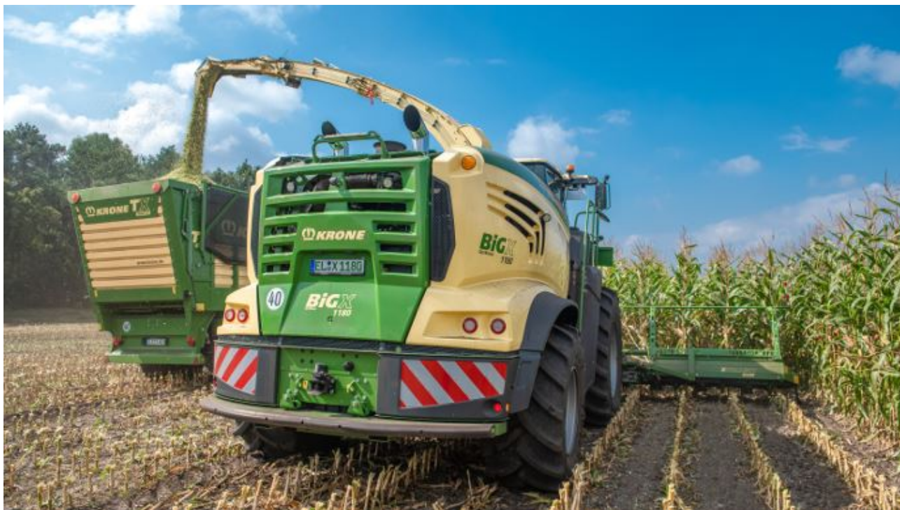
Le moteur de l'ensileuse Krone Big X 1 180 développe 1 156 ch de puissance. (©Krone)
