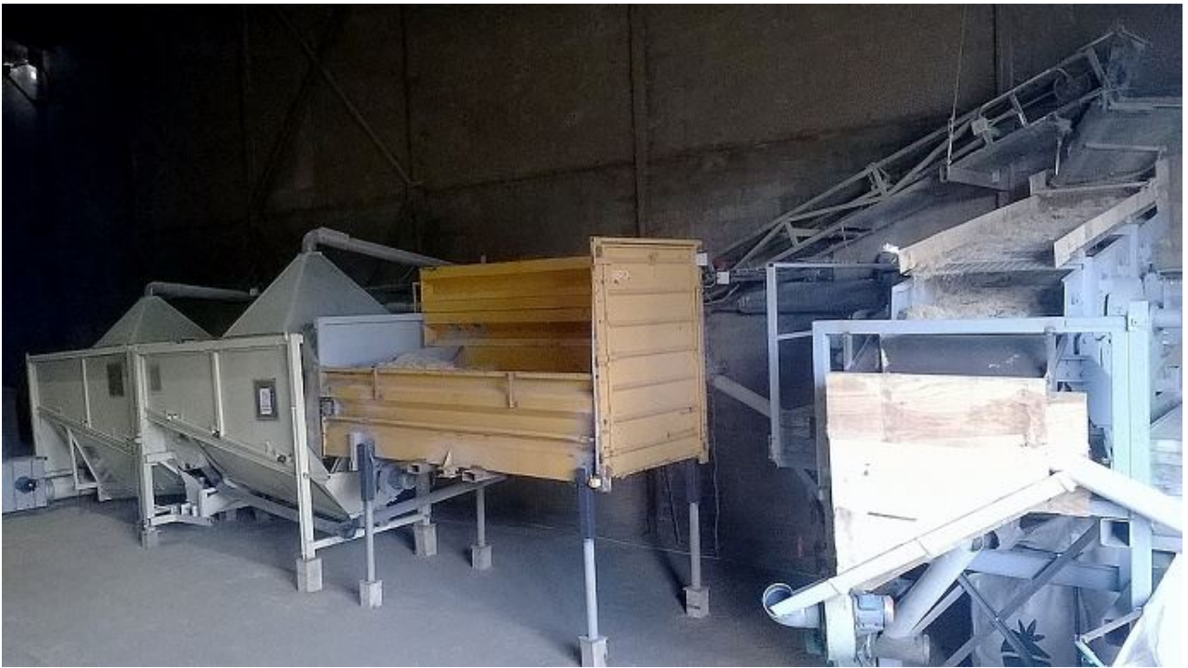
L'unité de défibrage a été entièrement conçue et assemblée « maison » par le groupe de producteurs. (©Le Chanvre Mellois)
