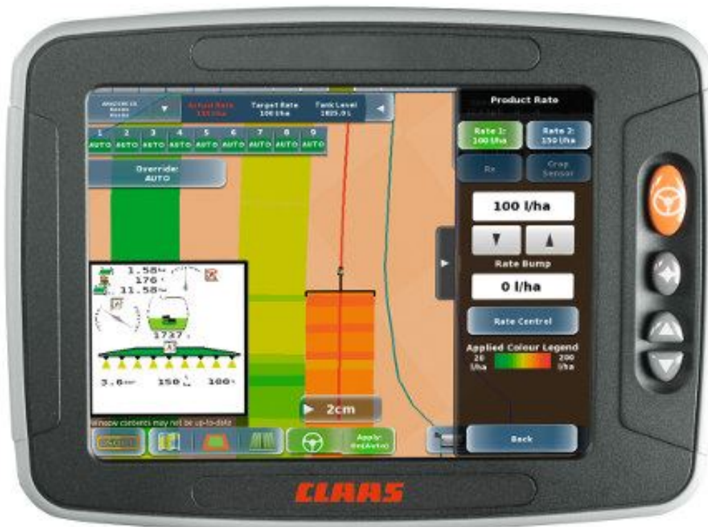
Le Claas S10 devient ainsi un terminal universel Isobus (@Claas)
