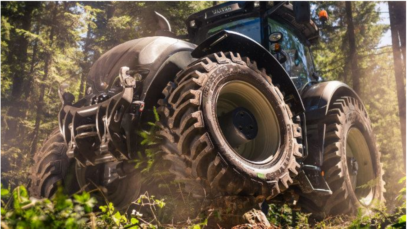
Flancs renforcés et barrettes supplémentaires, le Tractor King de Nokia est fait pour les travaux lourds (©Nokian)
