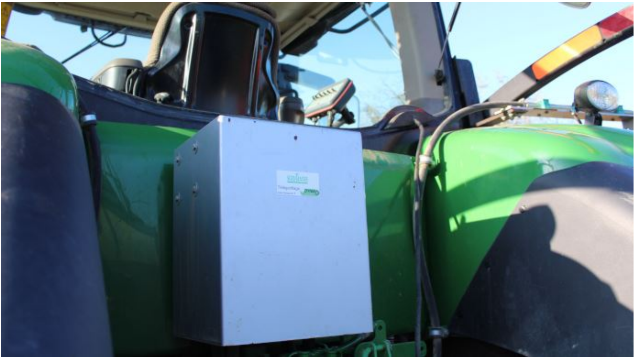
Le module de gestion de la pression des pneus est installé derrière la cabine du tracteur. (©Paul Renaud)
