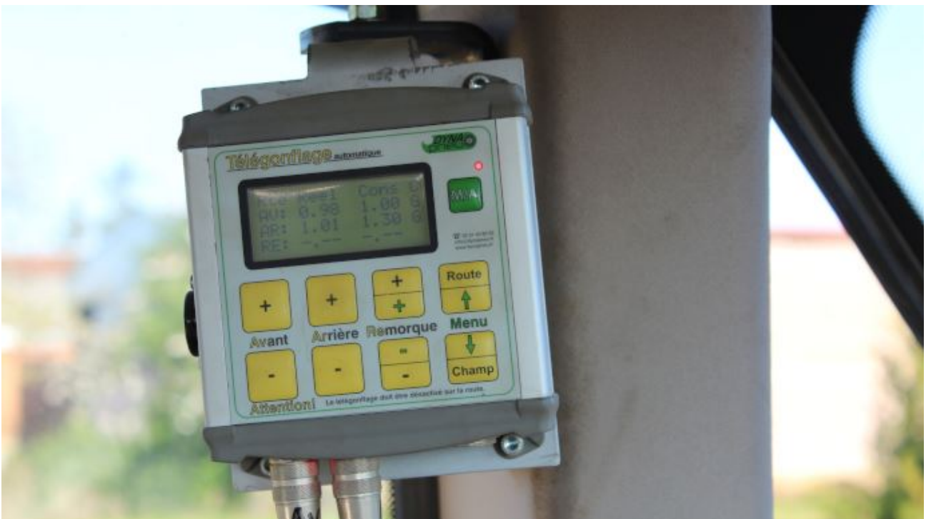
L'opérateur définit la pression de gonflage de ses pneus au travail et au transport puis passe de l'une à l'autre en un clic. (©Paul Renaud)
