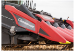
La gamme de cueilleurs Mais Star* Collect de Geringhoff andaine la paille de maïs. (©Geringhoff)
