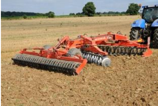
La conception avec poutre centrale améliore la rigidité, la visibilité et l'accessibilité d'après Kuhn. (© DR)
