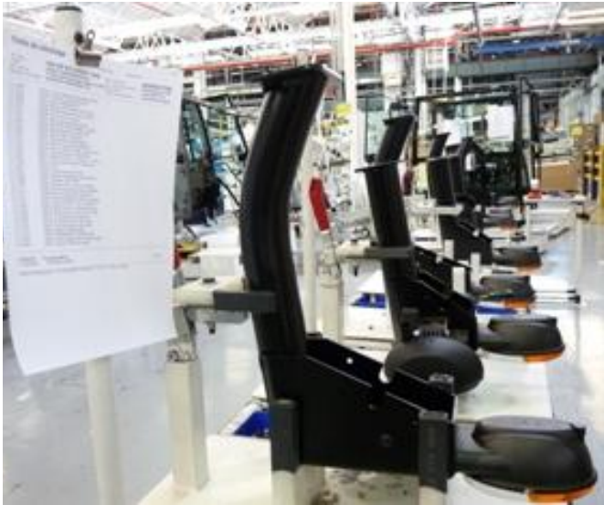
Comme dix-neuf modèles sont assemblés sur la même chaîne, une fiche avec toutes les caractéristiques suit chaque tracteur. (© Terre-net Média)
