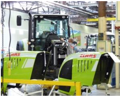
Ici, une des dernières étapes de la chaîne avec la pause du capot. (© Terre-net Média)
