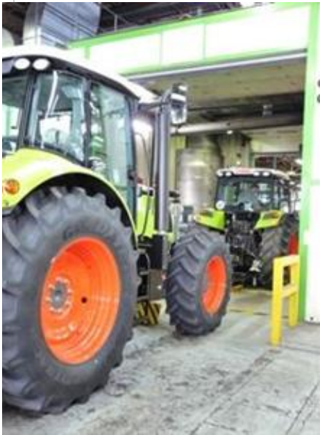
Dix portails qualité contrôlent le travail au fil de l'assemblage puis les tracteurs subissent encore une batterie de tests. (© Terre-net Média)
