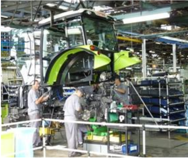
La fixation de la cabine demande beaucoup de précision pour assurer toutes les connexions électriques et électroniques. (© Terre-net Média)
