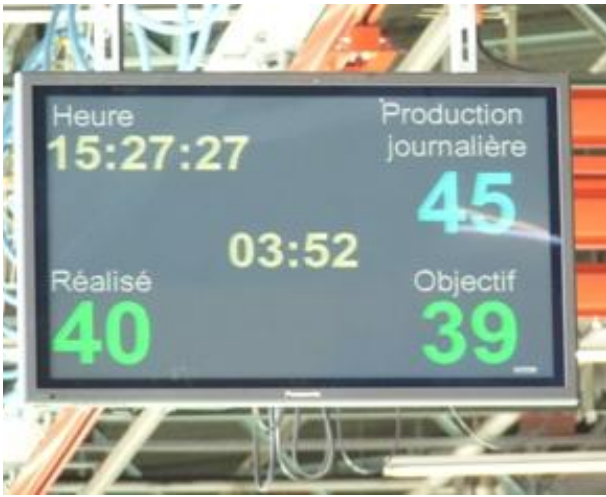
Des écrans lumineux permettent aux ouvriers de consulter l'objectif de la journée et l'état d'avancement. (© Terre-net Média)
