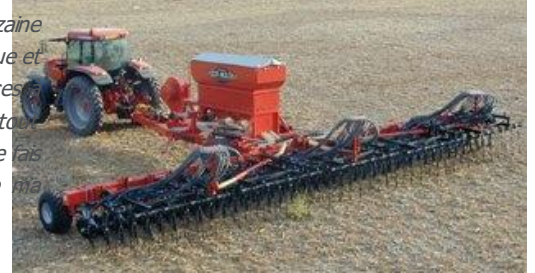
Le Magnum Drill comprend quatre rangées de peignes et une rangée de disques. (© DR)
