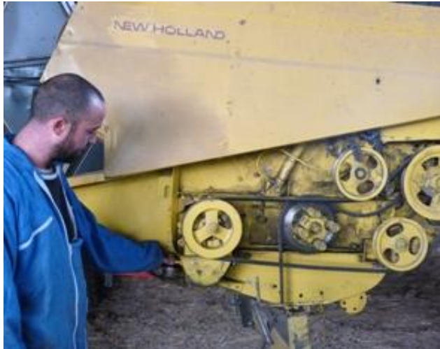
Vérification de la bielette d'une barre de coupe. (© Terre-net Média)
