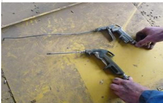
Les soufflettes : la plus grande est de fabrication maison à partir d'un tuyau de frein de voiture (© Terre-net Média)
