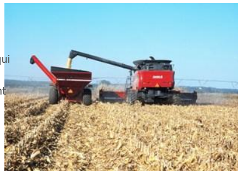
Après validation par le chauffeur, les autoguidages des deux machines se synchronisent. (© DR)
