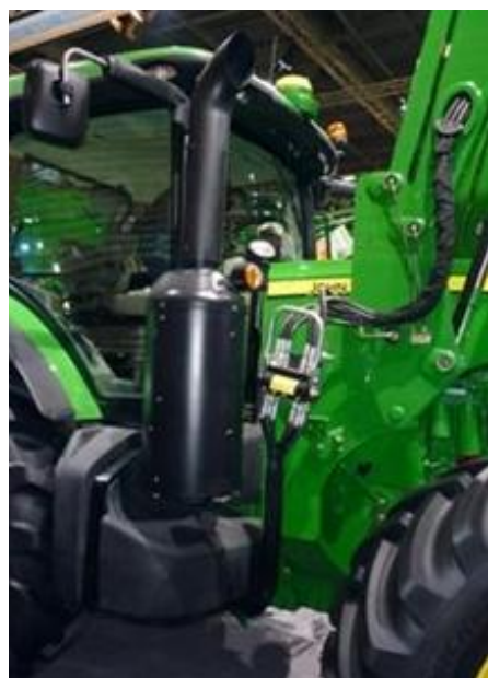
Echappement et filtre à particules du nouveau John Deere 8R. (© Terre-net Média)
