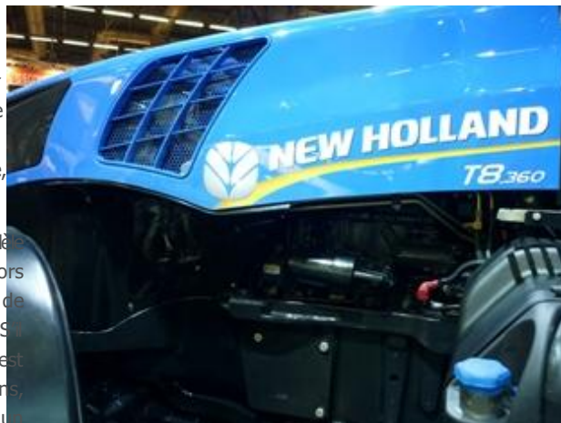
La capacité du réservoir d'AdBlue permet de ne devoir ravitailler en urée qu'à un plein de carburant sur deux. (© Terre-net Média)
