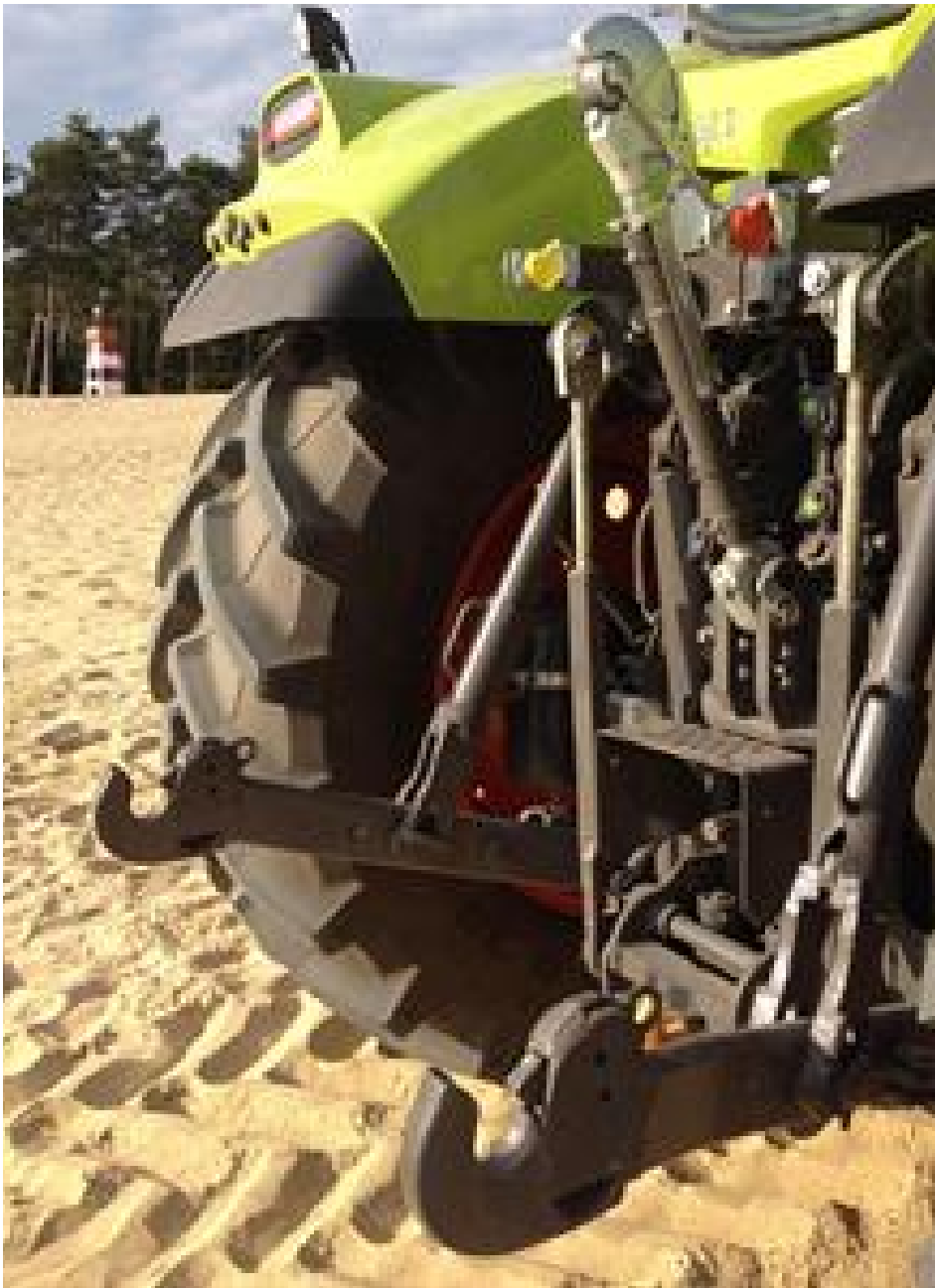
Relevage et débit hydraulique. De série, le tracteur est équipé de 4 distributeurs hydrauliques double effet. Le débit est de 110 l/min. La capacité maximum du relevage arrière varie de 6,5 à 8 tonnes en fonction des modèles. En option, à l'avant, elle est de 3 à 4 tonnes. (© Terre-net Média)
