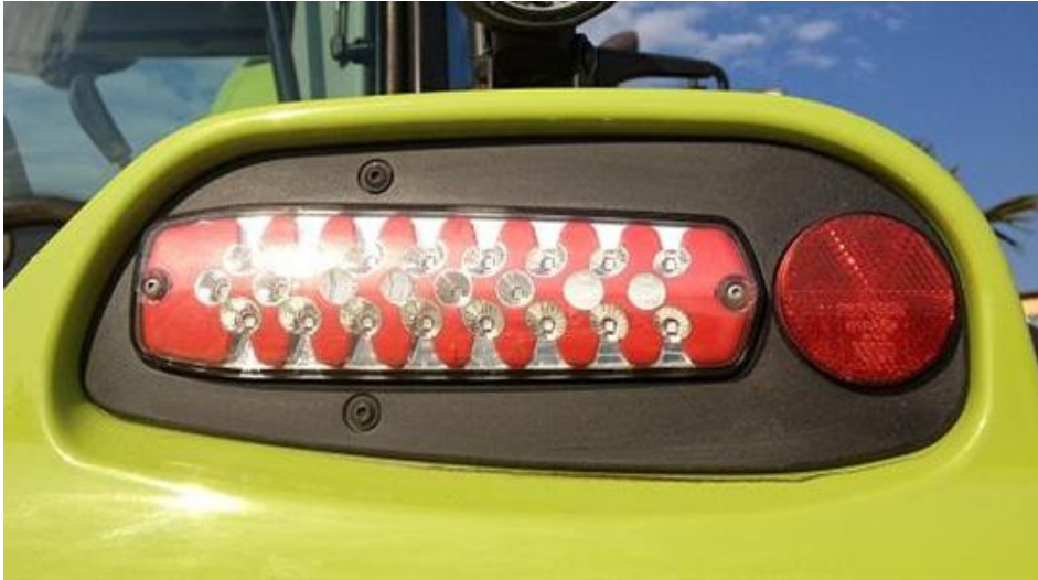
La classe ! En version Cebis exit les ampoules, les optiques arrières sont équipées de diodes. (© Terre-net Média)
