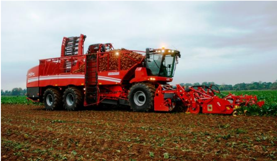
Les 2e et 3e essieux de la Rexor 630 sont directionnels. La machine peut également évoluer en crabe pour optimiser la répartition des masses sur le sol. (© Grimme)
