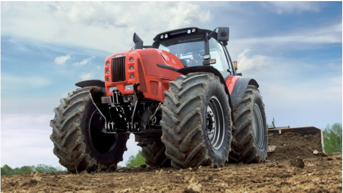
L'Audax ST peut travailler à des vitesses de 650 m/h à 40 km/h. (©Same)
