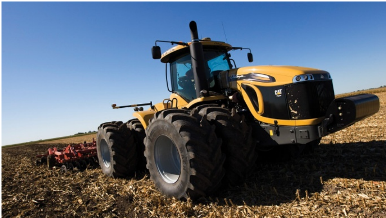
Le jumelage est une des solutions possibles pour augmenter la surface de contact tracteur/sol. (@Challenger)
